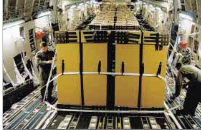
Ci-dessus : le personnel d'un C-17 américain inspecte le mécanisme de déchargement en vol des rations humanitaires. Chaque jour, les C-17 transportent quelque 37 000 rations qui sont larguées en Afghanistan à l'intention des réfugiés.
